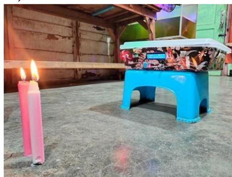
Gambar 4.8 memperlihatkan sebuah Sensor Api (Flame Detector) pada perancangan ini dapat bekerja dengan baik dan sesuai seperti yang diharapkan karena setelah sensor tersebut dapat mendeteksi adanya api maka terlihat sistem memberikan perintah untuk menyalakan Led merah, menyalakan buzzer kemudian menampilkan data pada Lcd (Liquid Crystal Display) serta memberikan
