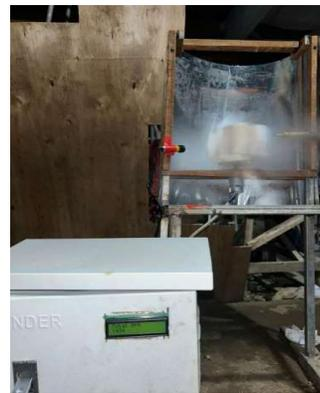
**Gambar 6. Proses Pengukuran Putaran Turbin serta Tegangan dan Arus pada Generator**
