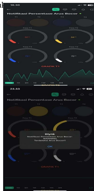
Gambar 11. Hasil Pengujian Notifikasi Arus Bocor dengan Blynk Smartphone
