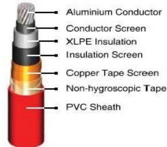
Gambar 2. Struktur Kabel XLPE 20 kV
