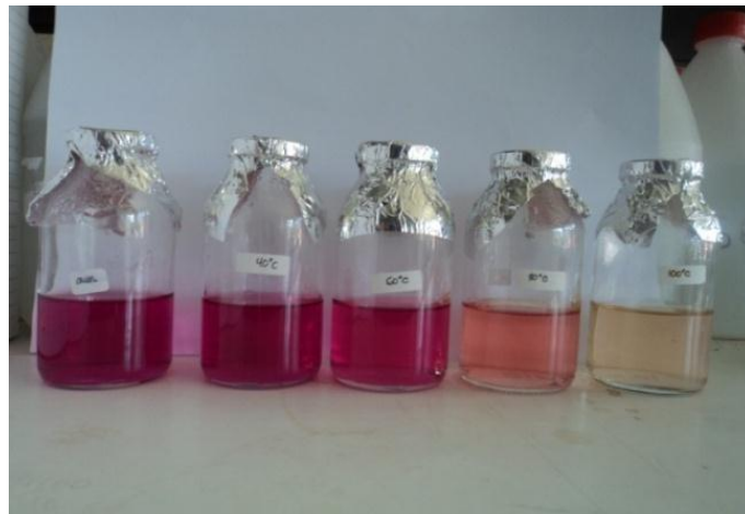
Gambar 7. Perubahan warna akibat pengaruh temperatur
